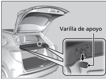
3. Desenganche las varillas de apoyo y, a continuación, retire la cubierta del maletero.
