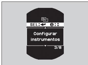
2. Pulse el botón hasta que **Configurar instrumentos** aparezca en la pantalla.
