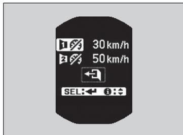
1. Pulse el botón /▼ hasta que aparezca la pantalla de ajuste de avisador de velocidad y, a continuación, pulse el botón **SEL/RESET**.
