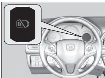
Los avisadores acústicos de advertencia pueden sonar dentro y/o fuera del vehículo para recordarle que el mando a distancia de acceso sin llave se encuentra fuera del vehículo. Si el aviso acústico continúa incluso después de introducir el mando a distancia en el vehículo, coloque el mando dentro de su alcance de funcionamiento.
