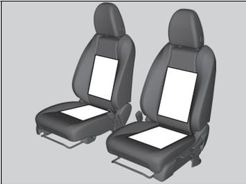
El interruptor de encendido debe estar en la posición de CONTACTO
