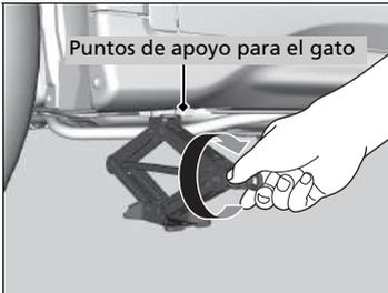
2. Gire el soporte del extremo hacia la derecha, como se muestra en la imagen, hasta que la parte superior del gato toque el punto de apoyo.
