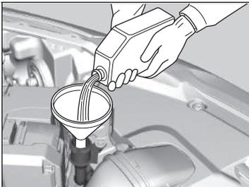
2. Si el nivel de refrigerante está por debajo de la marca **MIN**, añada el refrigerante especificado hasta que alcance la marca **MAX**.
