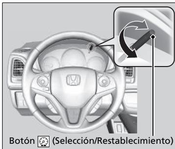
Cuando el interruptor de encendido está en la posición de CONTACTO **II**\*1, puede usar el botón (Selección/Restablecimiento) para ajustar el brillo del panel de instrumentos.
