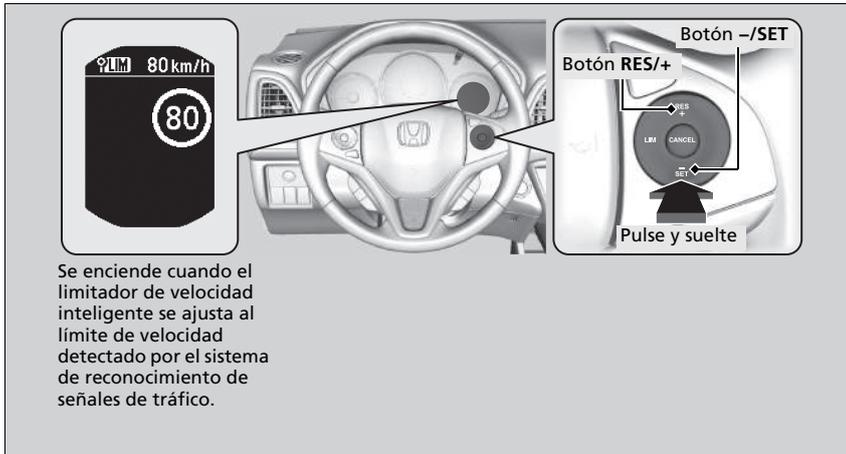
Se enciende cuando el limitador de velocidad inteligente se ajusta al límite de velocidad detectado por el sistema de reconocimiento de señales de tráfico.
