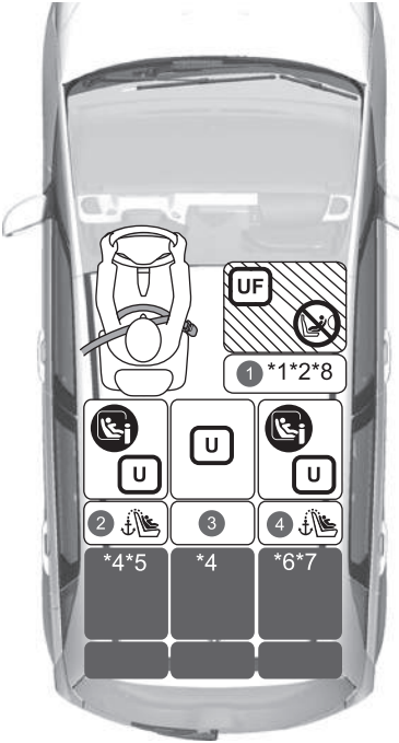
Airbag del pasajero activado en los modelos con volante a la izquierda
