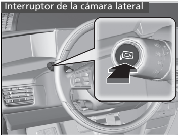
Interruptor de la cámara lateral
