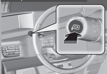
Interruptor de la cámara lateral
