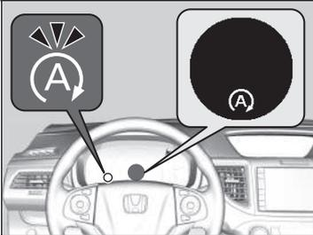
El motor se pone después en marcha cuando el vehículo está a punto de iniciar de nuevo la marcha, y el testigo se apaga.
