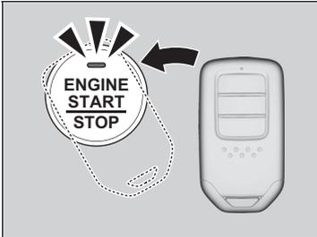
1. Toque la parte central del botón **ENGINE START/STOP** con el símbolo **H** del mando a distancia de acceso sin llave mientras parpadea el testigo del botón **ENGINE START/STOP**. Los botones del mando a distancia sin llave deben estar orientados hacia usted.
