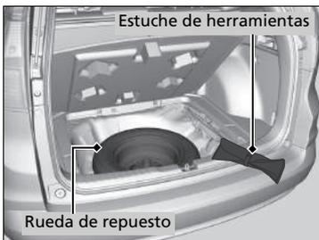
2. Saque la bolsa con las herramientas del maletero. Saque la llave para las tuercas de rueda y la barra para la manivela del gato de la bolsa con las herramientas.
