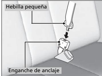
2. Alinee las marcas triangulares de la hebilla pequeña y del enganche de anclaje. Asegúrese de que el cinturón de seguridad no esté retorcido. Fije el cinturón de seguridad al enganche de anclaje.
