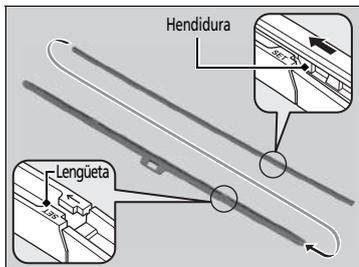
**4.** Saque la escobilla del limpiaparabrisas del soporte tirando del extremo con lengüeta hacia fuera.
