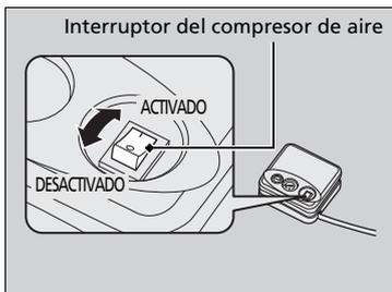
6. Conecte el compresor de aire a la toma de corriente para accesorios.
