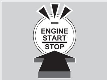
2. Pise el pedal de freno (transmisión automática) o el pedal de embrague (caja de cambios manual) y pulse el botón **ENGINE START/STOP** en el lapso de 10 segundos después de que haya sonado el avisador acústico y el testigo permanezca encendido.
