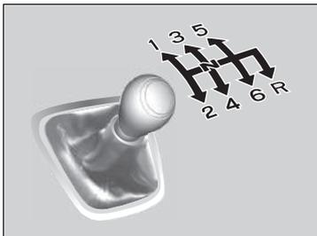
Cuando no esté cambiando de marcha, no apoye el pie sobre el pedal de embrague. Esto puede acelerar el desgaste del embrague.
