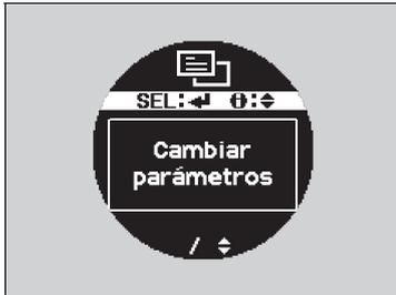
2. Pulse el botón hasta que aparezca **Cambiar parámetros** en la pantalla y, a continuación, pulse el botón **SEL/RESET**.
