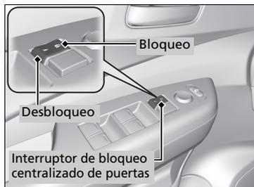
Pulse el interruptor de bloqueo centralizado de puertas hacia dentro como se muestra para bloquear o desbloquear todas las puertas y el portón trasero.
