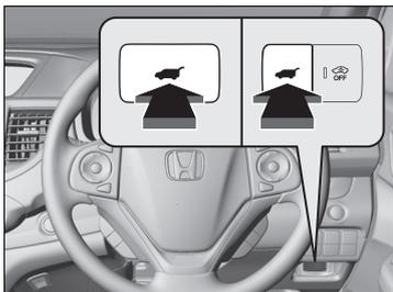
Para abrir: Mantenga pulsado el botón del portón trasero en el panel de control del lado del conductor durante un segundo aproximadamente.
