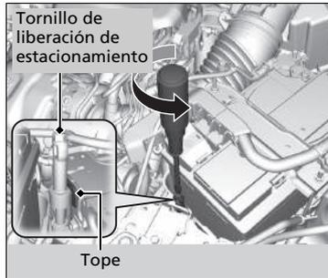
5. Inserte el destornillador en el cabezal roscado del tornillo de liberación de estacionamiento. Gire el tornillo hasta que alcance el tope.
