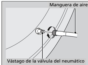
5. Ajuste la manguera de aire en el vástago de la válvula del neumático. Atornillela hasta que esté fija.
