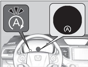
Si abre la puerta del conductor mientras el testigo se enciende, sonará un avisador acústico para indicarle que la función de parada automática en ralentí está activada.
