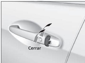
**Para cerrarla:** bloquee la puerta del conductor con la llave. Antes de que transcurran 10 segundos desde que la llave se colocó de nuevo en la posición central, gire la llave en el sentido de bloqueo y manténgala en esa posición.
