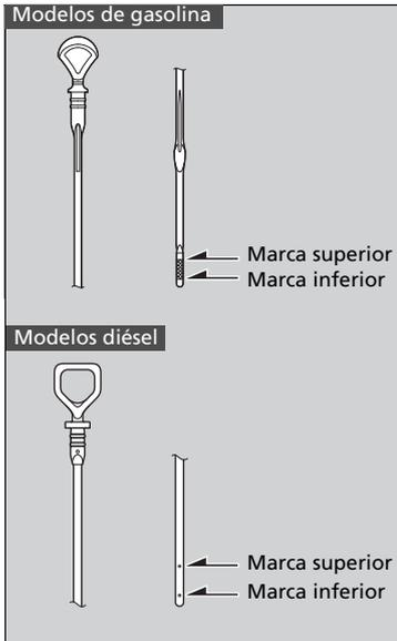
4. Retire de nuevo la varilla de medición del nivel y compruebe el nivel. Debería encontrarse entre las marcas superior e inferior. Si es necesario, añada aceite.
