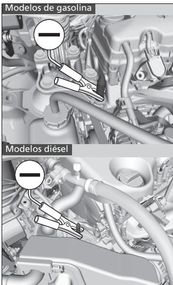
4. Conecte el otro extremo del segundo cable de arranque con pinzas al tornillo de montaje del motor como se muestra en la imagen. No conecte este cable de arranque con pinzas a ninguna otra parte.
