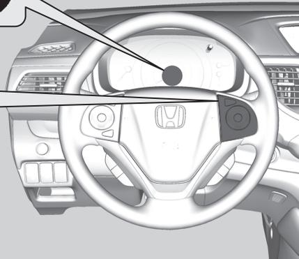
Si aparece un panel de instrumentos distinto, pulse el botón **LIM** para cambiarlo al de control de cruce.
