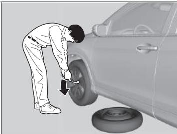
5. Coloque un calzo para ruedas o una roca delante y detrás de la rueda opuesta en diagonal al neumático pinchado.
