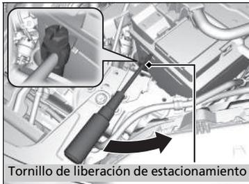
4. Inserte un destornillador en el orificio del eje del perno de liberación de estacionamiento.
