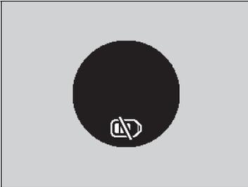
Los avisadores acústicos de advertencia pueden sonar dentro y/o fuera del vehículo para recordarle que el mando a distancia sin llave se encuentra fuera del vehículo. Si el avisador acústico continúa incluso después de meter el mando a distancia en el vehículo, coloque el mando dentro de su radio de alcance de funcionamiento.
