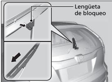
2. Levante la lengüeta de bloqueo y saque el brazo del limpiaparabrisas.
