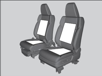
El interruptor de encendido debe estar en la posición de CONTACTO **II**\*1 para utilizar la calefacción de los asientos. En la posición de **HI**, los asientos se calientan más rápidamente que en la posición de **LO**.
