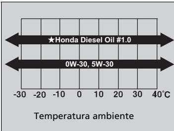
Utilice un aceite del motor comercial del grado de viscosidad adecuado para la temperatura ambiente según se muestra.
