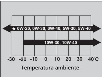
Utilice aceite motor original de Honda u otro aceite del motor comercial del grado de viscosidad SAE adecuado para la temperatura ambiente según se indica.
