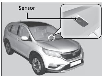
El sistema automático de climatización cuenta con diferentes sensores. No los tape ni vierta líquidos sobre ellos.
