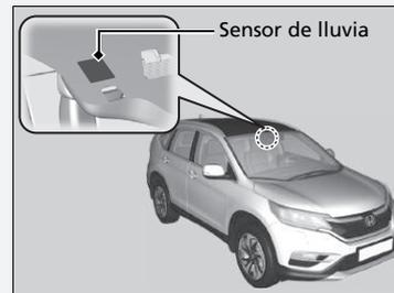
No ponga la palanca del limpiaaparabrisas en la posición de **AUTO** si está limpiando el parabrisas o se encuentra en un túnel de lavado. Si la palanca del limpiaaparabrisas está en la posición de **AUTO** y el interruptor de encendido en la posición de CONTACTO [II]<sup>\*1</sup>, el sensor de lluvia puede responder a sus manos o a los líquidos de lavado del vehículo y los limpiaaparabrisas pueden activarse automáticamente.
