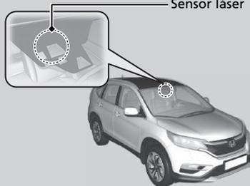
El sistema se activa cuando la diferencia de velocidad entre su vehículo y el vehículo detectado delante está entre 5 km/h y 32 km/h aproximadamente y existe una alta posibilidad de colisión.
