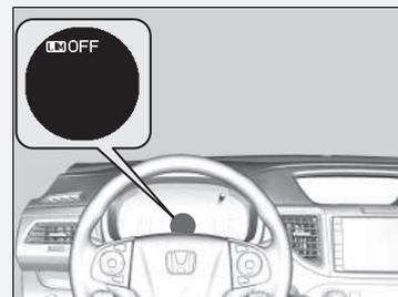
Si hay un problema con el sistema cuando está utilizando el limitador de velocidad ajustable, suena el avisador acústico y **OFF** se enciende. El limitador de velocidad ajustable se desactivará.
