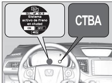
Puede activar y desactivar el sistema mediante la de información múltiple.
