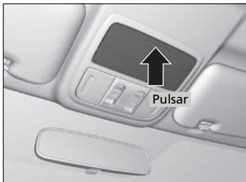
Para abrir el compartimento para las gafas de sol, pulse la zona marcada y suéltela. Presione hasta que se enganche para cerrarlo.
