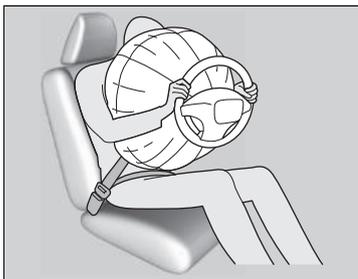
Mientras el cinturón de seguridad sujeta el torso, el airbag delantero ofrece protección suplementaria para la cabeza y el tórax.
