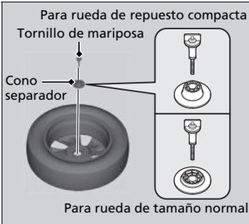
2. Coloque el neumático desinflado boca abajo en el espacio de la rueda de repuesto.
