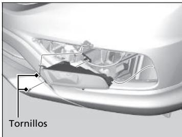
2. Quite el tornillo con un destornillador de estrella y tire con cuidado del conjunto de faro antiniebla para extraerlo del parachoques.
