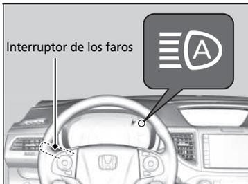
Gire el interruptor de los faros a la posición de **AUTO** y coloque la palanca de las luces de carretera en luces de cruce.
