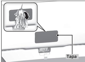
1. Con un destornillador de punta plana retire la tapa de la parte trasera del portón trasero.
