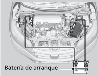
1. Conecte el primer cable de arranque con pinzas al terminal  $\oplus$  de la batería del vehículo.
