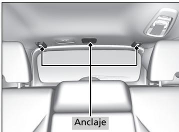
Se proporcionan tres puntos de anclaje de sujeción en el techo para los asientos traseros. Un sistema de sujeción para niños que se instala con un cinturón de seguridad y que viene con una cinta de sujeción permite utilizar la cinta para mayor seguridad.
