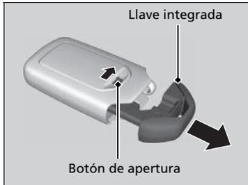
Se puede utilizar la llave integrada para bloquear las puertas cuando la pila del mando a distancia sin llave se está agotando y el bloqueo/desbloqueo eléctrico de las puertas está desactivado.
