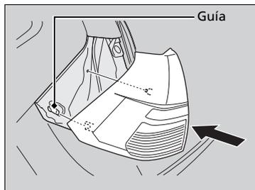
5. Vuelva a instalar el conjunto de luces deslizándolo por la guía de la carrocería.
