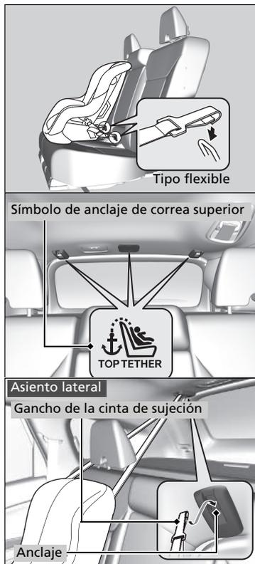
► Instalación de un sistema de sujeción para niños compatible con anclaje inferior
