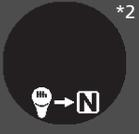
*2 | <ul style="list-style-type: none"> <li>Aparece al mover la palanca de cambios de <b>[N]</b> a cualquier otra posición sin pisar el pedal del embrague mientras el sistema de parada automática al ralentí está activado.</li> </ul>
