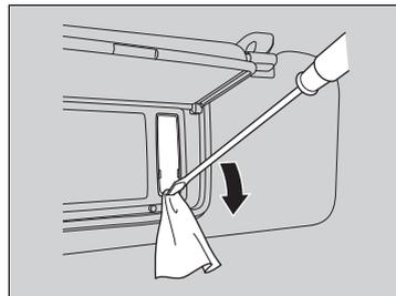
1. Haga palanca en el borde de la tapa con un destornillador de punta plana para retirarla.
