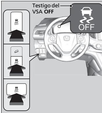
Este botón se encuentra en el panel de mandos del lado del conductor. Para activar y desactivar parcialmente el sistema VSA, manténgalo pulsado hasta que escuche un tono.
