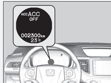
Aunque el control de cruceo adaptativo se haya cancelado automáticamente, podrá volver a la velocidad fija anterior. Espere hasta que la condición que provocó la cancelación del ACC mejore y pulse el botón **RES/+**.
