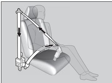
Los pretensores mecánicos son los encargados de comenzar a retraer los cinturones de seguridad delanteros cuando el CMBS, el sistema de asistencia al frenado o el sistema VSA están en funcionamiento. También se pueden activar si el vehículo realiza un giro completo o se produce un impacto en el vehículo. Una vez retraídos, los cinturones de seguridad volverán a sus posiciones originales.
