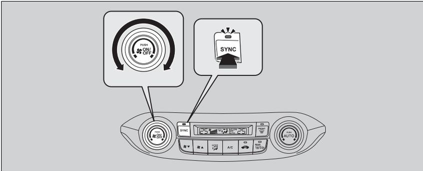
Es posible ajustar la temperatura sincrónicamente para el lado del conductor y el lado del pasajero en modo sincronizado.
