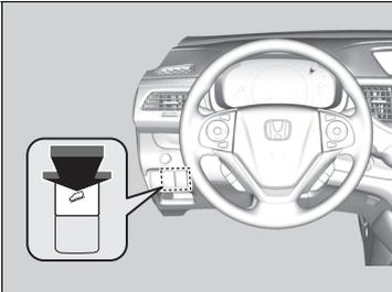
Mantenga la velocidad del vehículo estable mientras descienda una pendiente sin pisar el pedal de freno o del acelerador.
