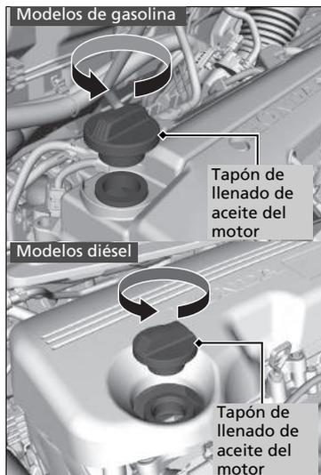
1. Desenrosque y retire el tapón de llenado de aceite del motor.
