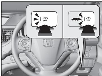
Para desactivar el sistema de sensores de ultrasonido, pulse el botón OFF del sensor de ultrasonido después de haber sacado la llave del interruptor de encendido o con la llave en la posición ACCESORIOS **I** o BLOQUEO **0**\*<sup>1</sup>.
