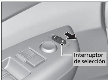
Si está activada esta función, el retrovisor del pasajero se inclina automáticamente hacia abajo cuando se cambia a la marcha **R**. Esta función mejora la visibilidad en el lado del pasajero al dar marcha atrás. El retrovisor regresa automáticamente a su posición original cuando se sale de la marcha **R**.
