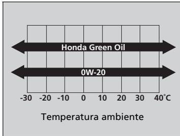
Utilice "aceite Honda Green" u otro aceite del motor comercial del grado de viscosidad adecuado para la temperatura ambiente según se indica.
