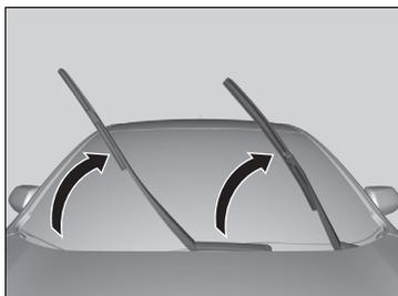
1. Levante primero el brazo del limpiaparabrisas del lado del conductor y después el del lado del pasajero.
