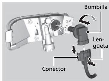
3. Presione la lengüeta para desmontar el acoplador.
