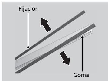
4. Retire las fijaciones de la escobilla del limpiaparabrisas y móntelas en una escobilla de goma nueva.
