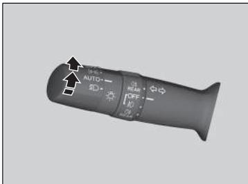
El control automático de luces se puede utilizar con el interruptor de encendido en la posición de CONTACTO
