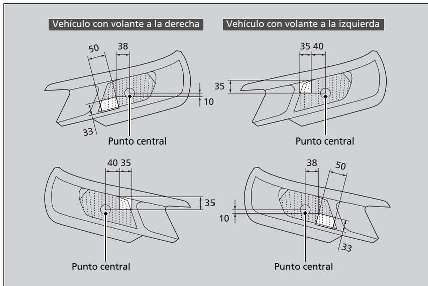
1. Prepare dos piezas rectangulares de cinta adhesiva, de 33 mm de ancho y 50 mm de largo, y de 35 mm de ancho y 35 mm de largo.
