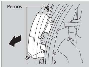
1. Use un destornillador de estrella para retirar los tornillos.
