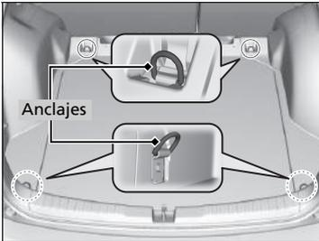
Los anclajes de amarre en el suelo del maletero se pueden utilizar para instalar una red para sujetar objetos.
