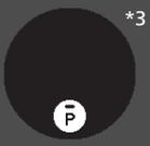
*3 | <ul style="list-style-type: none"> <li>Aparece cuando el motor se detiene sin que se haya cambiado a <b>[P]</b> y no se puede volver a arrancar automáticamente.</li> <li>Aparece si se abre el capó mientras se activa la parada automática en ralentí.</li> </ul>
