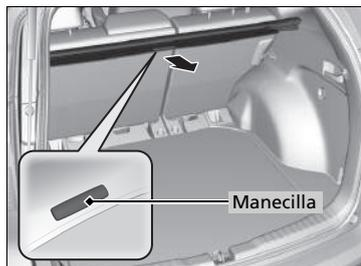
La cubierta del compartimento posterior se puede utilizar para ocultar objetos en la zona del maletero y protegerlos de la incidencia directa de la luz solar.
