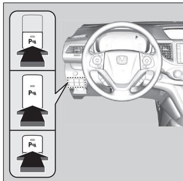
Con el interruptor de encendido en la posición de CONTACTO **II**\*1, pulse el botón del sistema del sensor de estacionamiento para activar o desactivar el sistema. El testigo del botón se enciende cuando el sistema está activado.
