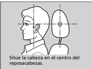
Los reposacabezas resultan más efectivos para evitar el llamado efecto latigazo y otras lesiones por impacto trasero cuando la parte central posterior de la cabeza del ocupante está a la altura del centro del reposacabezas. La parte superior de las orejas del ocupante deberá quedar a la altura del centro del reposacabezas.
