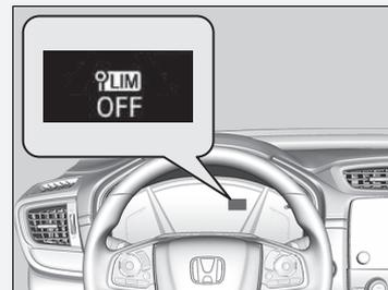
Si hay un problema con el sistema o el sistema de reconocimiento de señales de tráfico cuando está utilizando el limitador de velocidad inteligente, suena el avisador acústico y se enciende el testigo **OFF**. El limitador de velocidad inteligente se desactivará.
