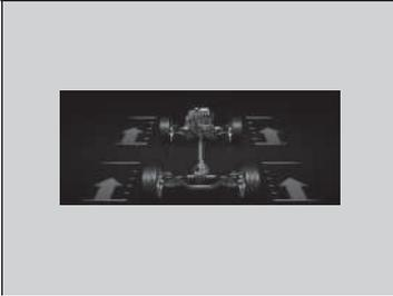
Los indicadores de la pantalla indican la cantidad de par que se transmite a las ruedas delantera derecha, delantera izquierda, trasera derecha y trasera izquierda.
