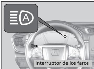
Para activar el sistema, gire el interruptor de los faros a **AUTO** y, a continuación, ajuste los faros a luz de cruce. El testigo de luces de carretera automáticas se enciende.
