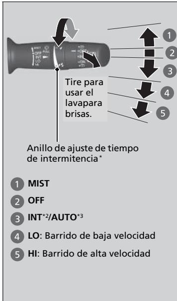
Los limpiaaparabrisas y lavaparabrisas se pueden utilizar cuando el interruptor de encendido está en la posición de CONTACTO \*<sup>1</sup>.
