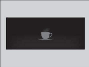
Si el número de barras disminuye a una, sonará un pitido, el volante vibrará y la taza de café se mostrará de color ámbar para avisar al conductor de que necesita descansar ya que su nivel de atención es muy bajo.
