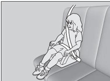
Si no se puede utilizar correctamente un cinturón de seguridad de tres puntos, siente al niño en un elevador en uno de los asientos traseros. Por la seguridad del niño, compruebe que el niño cumple las recomendaciones del fabricante para el uso del elevador.
