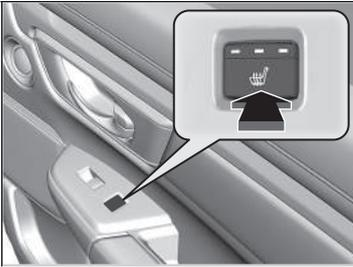
El modo de alimentación debe ser CONTACTO para poder utilizar la calefacción de los asientos. No hay calefacción en los asientos traseros centrales.
