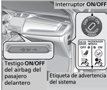
Cuando el interruptor **ON/OFF** del airbag del pasajero delantero está en la posición: **OFF**: el airbag del acompañante delantero está desactivado. El airbag del pasajero delantero no se infla durante una colisión frontal en la que se infla el airbag delantero del conductor.
