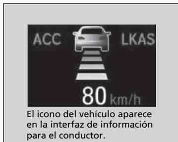
Cuando delante de usted se detecta un vehículo a menor velocidad que la que usted ha programado, su vehículo empieza a disminuir la velocidad.
