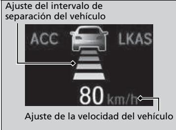
Cuando el sistema ACC con LSF empieza a funcionar, el icono del vehículo, las barras de intervalo y la velocidad fija aparecen en la interfaz de información para el conductor.
