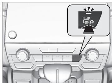
La luneta térmica y los retrovisores térmicos se desactivan automáticamente transcurridos de 10 a 30 minutos, en función de la temperatura exterior. Sin embargo, si la temperatura exterior es de 0 °C o inferior, no se desconectan automáticamente.
