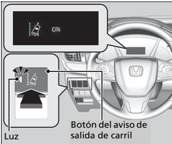
Pulse el botón del sistema de aviso de salida de carril para encender y apagar el sistema.
