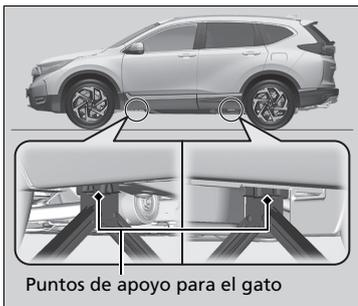
1. Coloque el gato debajo del punto de apoyo más cercano al neumático que va a cambiarse.
