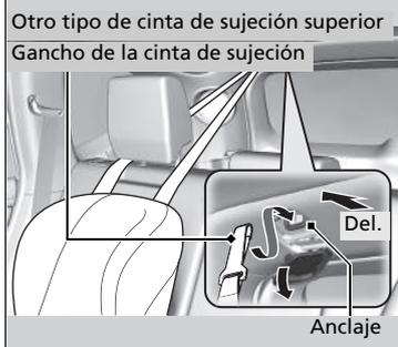
4. Abra la cubierta del anclaje de atadura.
