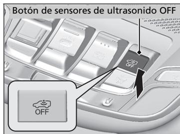
Para desactivar el sistema de sensores de ultrasonido, pulse el botón OFF del sensor de ultrasonido después de haber sacado la llave del interruptor de encendido o con la llave en la posición ACCESORIOS [1] o BLOQUEO [0]\*1.
