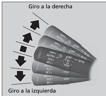
Los intermitentes se pueden utilizar cuando el interruptor de encendido está en la posición de CONTACTO \*1.
