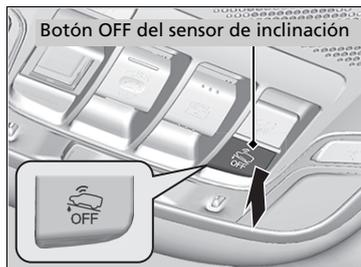
Para desactivar el sistema del sensor de inclinación, pulse el botón OFF después de haber sacado la llave del interruptor de encendido o con la llave en la posición ACCESORIOS **I** o BLOQUEO **0**\*1.
