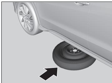
**7.** Coloque la rueda de repuesto (con la llanta hacia arriba) debajo del vehículo, cerca del neumático que va a sustituir.
