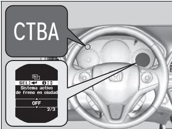
Puede activar y desactivar el sistema mediante la pantalla de información múltiple.
