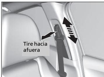
1. Mueva el anclaje hacia arriba y hacia abajo mientras tira del anclaje del hombro hacia afuera.
