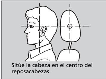
Los reposacabezas resultan más efectivos para evitar el llamado efecto latigazo y otras lesiones por impacto trasero cuando la parte central posterior de la cabeza del ocupante está a la altura del centro del reposacabezas. La parte superior de las orejas del ocupante debe quedar a la altura del centro del reposacabezas.
