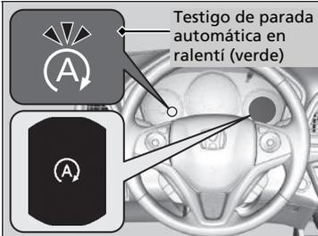
El motor se pone nuevamente en marcha cuando el vehículo está a punto de ponerse en movimiento otra vez cuando pisa el pedal de embrague y el testigo (verde) se apaga.
