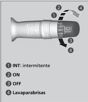
Los limpiaaparabrisas y lavaparabrisas traseros se pueden utilizar cuando el interruptor de encendido está en la posición de CONTACTO **II**\*1.
