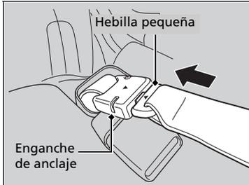
2. Alinee las marcas triangulares de la hebillita pequeña y del enganche de anclaje. Asegúrese de que el cinturón de seguridad no esté retorcido. Fije el cinturón de seguridad al enganche de anclaje.
