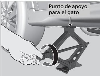
1. Coloque el gato debajo del punto de apoyo más cercano al neumático que va a cambiarse.
