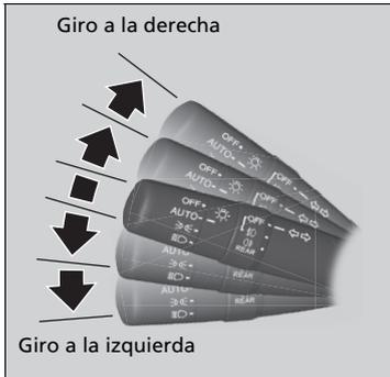
Los intermitentes se pueden utilizar cuando el interruptor de encendido está en la posición de CONTACTO
