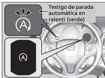
El motor se pone después en marcha cuando el vehículo está a punto de iniciar de nuevo la marcha, y el testigo (verde) se apaga.
