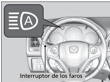
Para activar el sistema, gire el interruptor de los faros a **AUTO** y ajuste los faros a luz de cruce. El testigo de luces de carretera automáticas se enciende.
