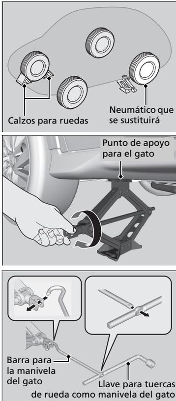
7. Coloque un calzo para ruedas o una roca delante y detrás de la rueda opuesta en diagonal al neumático pinchado.
