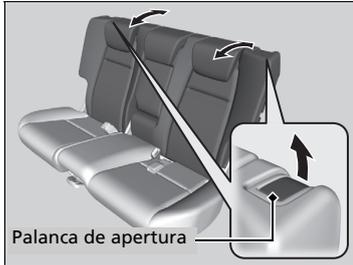
Tire de la palanca de la derecha para cambiar el ángulo de la mitad derecha del respaldo y de la palanca de la izquierda para la mitad izquierda.
