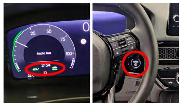
Luego, retire la llave electrónica y manténgase como mínimo a 5 m del vehículo
