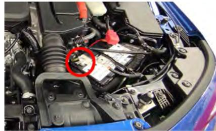
**2. Se puede desactivar el sistema de alta tensión en el compartimento del motor**
