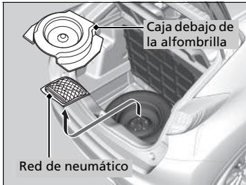
7. Retire la caja que hay debajo del suelo y luego extraiga la red del neumático.
