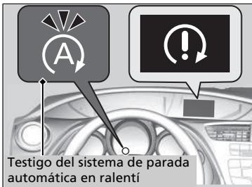
El motor se pone nuevamente en marcha cuando el vehículo está a punto de ponerse en movimiento otra vez cuando pisa el pedal de embrague y el testigo se apaga.
