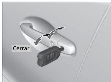
**Para cerrarlo:** Bloquee la puerta del conductor con la llave. Antes de que transcurran 10 segundos desde que la llave se colocó de nuevo en la posición central, gire la llave en el sentido de bloqueo y manténgala en esa posición.
