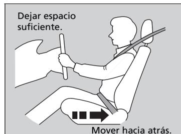
Ajuste el asiento del conductor lo más atrás posible siempre que le permita mantener el control total del vehículo. Deberá poder sentarse con la espalda recta bien apoyada en el respaldo y pisar adecuadamente los pedales, sin tener que inclinarse hacia delante, y agarrar el volante con comodidad. El asiento del pasajero deberá ajustarse de forma similar para que permanezca lo más lejos posible del airbag delantero del salpicadero.
