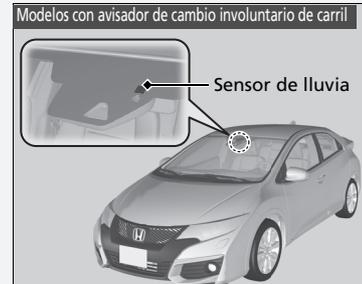
No ponga la palanca del limpiaaparabrisas en la posición de **AUTO** si está limpiando el parabrisas o se encuentra en un túnel de lavado. Si la palanca del limpiaaparabrisas está en la posición de **AUTO** y el interruptor de encendido en la posición de CONTACTO **II**<sup>\*1</sup>, el sensor de lluvia puede responder a sus manos o a los líquidos de lavado del vehículo y los limpiaaparabrisas pueden activarse automáticamente.
