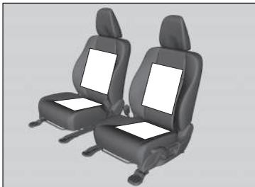
El interruptor de encendido debe estar en la posición de CONTACTO **II**\*\* para utilizar la calefacción de los asientos. En la posición de **HI**, los asientos se calientan más rápidamente que en la posición de **LO**.
