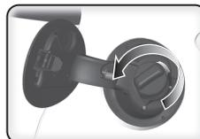
**3** Coloque el tapón en el compartimento de la tapa del depósito de combustible.
