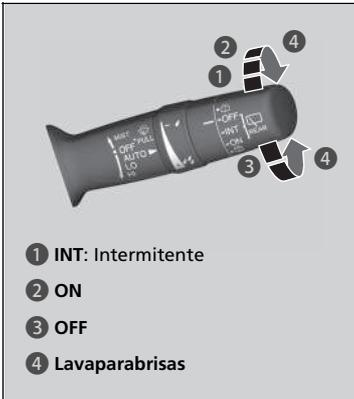
Los limpiaparabrisas y lavaparabrisas se pueden utilizar cuando el interruptor de encendido está en la posición de CONTACTO **II**\*1.
