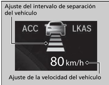
Cuando el sistema ACC con LSF empieza a funcionar, el icono del vehículo, las barras de intervalo y la velocidad programada aparecen en la interfaz de información del conductor.
