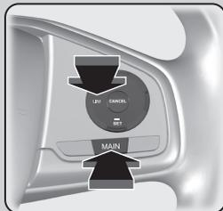
Si se enciende un testigo diferente, pulse el botón **LIM** para cambiar al control de cruce.
