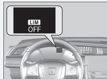
Si hay un problema con el sistema cuando está utilizando el limitador de velocidad ajustable, suena el avisador acústico y se enciende el testigo **OFF**. El limitador de velocidad ajustable se desactivará.
