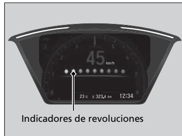
Se enciende de izquierda a derecha según la velocidad del motor.
