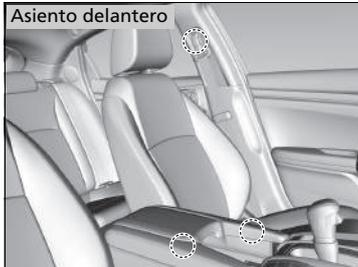
Al sustituir los cinturones de seguridad, utilice los puntos de anclaje que se muestran en las imágenes. El asiento delantero dispone de un cinturón de seguridad de tres puntos.
