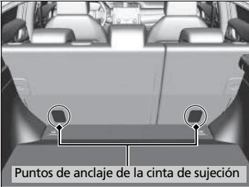
Hay dos puntos de anclaje para la cinta de sujeción detrás de cada asiento trasero exterior. Si tiene un sistema de sujeción para niños que incluye una cinta pero que puede instalarse con un cinturón de seguridad, la cinta podrá usarse para mayor seguridad.
