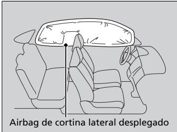
El airbag de cortina lateral está diseñado para desplegarse en un impacto lateral de moderado a fuerte.
