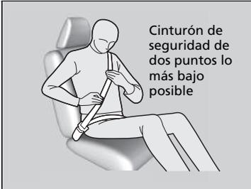
3. Coloque la sección de la cadera del cinturón de seguridad lo más baja posible sobre las caderas y después tire hacia arriba de la sección del hombro para que la sección de la cadera quede bien ajustada. De este modo, los robustos huesos pélvicos recibirán la fuerza del impacto, lo que reduce el riesgo de lesiones internas.
