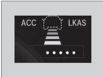
Si no le precede ningún vehículo antes de reanudar la conducción, pise el pedal del acelerador y el ACC con LSF se pondrá en marcha de nuevo dentro de los límites de la velocidad fijada anteriormente.
