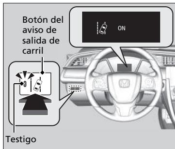
Pulse el botón del aviso de salida de carril para encender y apagar el sistema.
