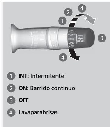
El limpiaparabrisas y el lavaparabrisas se pueden utilizar cuando el interruptor de encendido está en la posición de CONTACTO **II**\*1.
