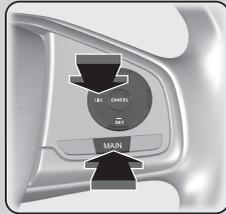
Si se enciende un testigo diferente, pulse el botón **LIM** para cambiar al limitador de velocidad ajustable.
