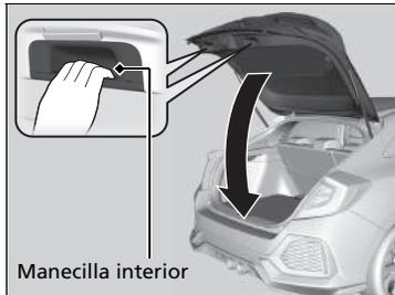
Al desbloquear todas las puertas o al pulsar el botón de desbloqueo de portón trasero mando a distancia, se desbloqueará el portón trasero. Pulse el botón de apertura del portón trasero y levante para abrirlo.
