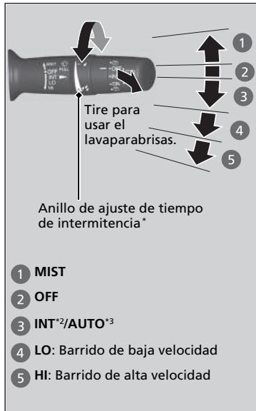
Los limpiaaparabrisas y lavaparabrisas se pueden utilizar cuando el interruptor de encendido está en la posición de CONTACTO \*1.
