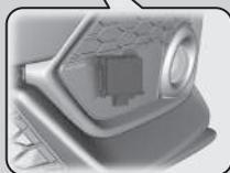
El sensor de radar está en la parte inferior del parachoques, junto a la luz antiniebla\*. Tenga cuidado de no golpear la cubierta del sensor de radar. Un impacto fuerte puede dañarlo.
