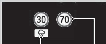
Señal de límite de velocidad en función de las condiciones\*2
