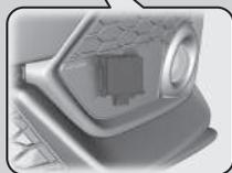
El sensor de radar está en la parte inferior del parachoques, junto a la luz antiniebla\*.
