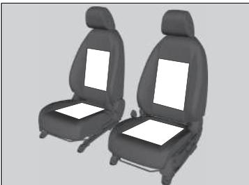
El interruptor de encendido debe estar en la posición de CONTACTO
