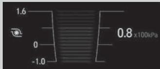
Cuando el turbo está produciendo sobrealimentación, este medidor muestra la presión de sobrealimentación.
