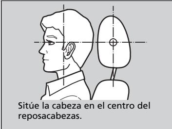
Los reposacabezas delanteros resultan más efectivos para evitar el llamado efecto latigazo y otras lesiones por impacto trasero cuando la parte central posterior de la cabeza del ocupante está a la altura del centro del reposacabezas. La parte superior de las orejas del ocupante deberá quedar a la altura del centro del reposacabezas.
