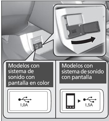
Instale el conector USB del dispositivo o la unidad de memoria USB en el puerto USB.
