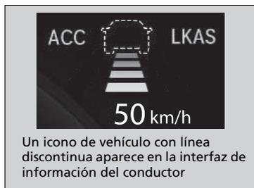
Su vehículo mantiene la velocidad fijada sin tener que mantener el pie sobre el pedal de freno ni del acelerador.
