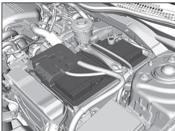
1. Abra la tapa de la caja de fusibles por el terminal positivo  $\oplus$  de la batería de su vehículo.
