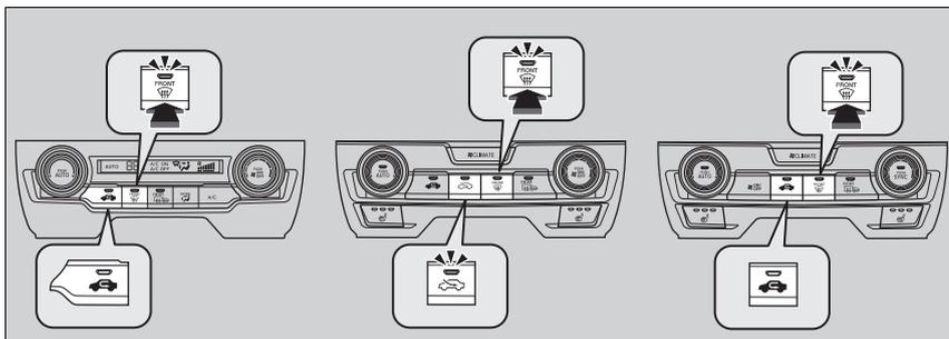
Al pulsar el botón
