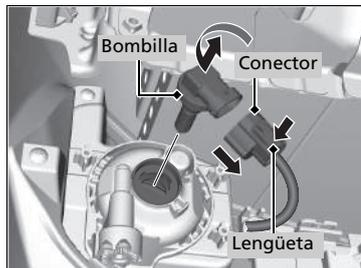
2. Presione la lengüeta para desmontar el acoplador.
