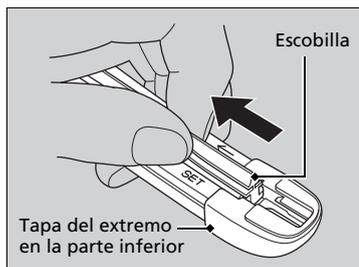
5. Tire del extremo de la escobilla del limpiaparabrisas en la dirección de la flecha de la imagen hasta que esté fuera de la tapa del extremo del soporte.
