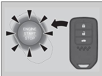
1. Toque la parte central del botón **ENGINE START/STOP** con el símbolo **H** del mando a distancia de acceso sin llave mientras el botón **ENGINE START/STOP** parpadea. Los botones del mando a distancia sin llave deben estar orientados hacia usted.
