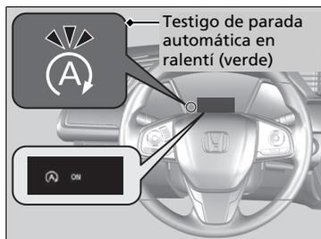
Un mensaje relativo a la parada automática en ralentí aparece en la interfaz de información para el conductor.
