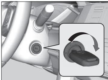
3. Espere hasta que el indicador de las bujías incandescentes se apague, a continuación, gire el interruptor a la posición START **III** sin pisar el pedal del acelerador.
