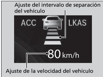
Cuando el sistema ACC empieza a funcionar, el icono del vehículo, las barras de intervalo y la velocidad programada aparecen en la interfaz de información del conductor.
