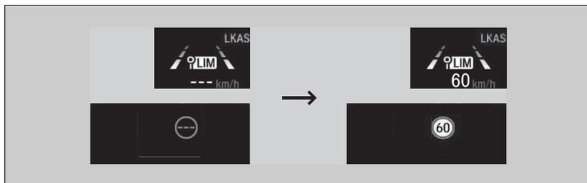
■ **Si el sistema de reconocimiento de señales de tráfico no detecta la señal de límite de velocidad mientras el limitador de velocidad inteligente está activado**
