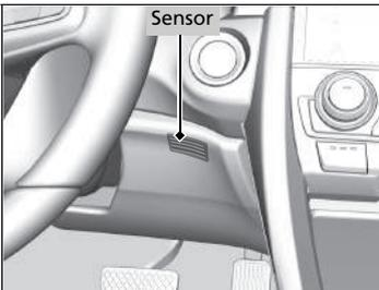
El sistema automático de climatización cuenta con diferentes sensores. No los tape ni vierta líquidos sobre ellos.
