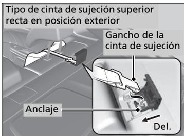
2. Suba el reposacabezas a su posición más alta, dirija la correa de sujeción a través de las patas del reposacabezas y sujete el gancho de la correa de sujeción en el anclaje.
