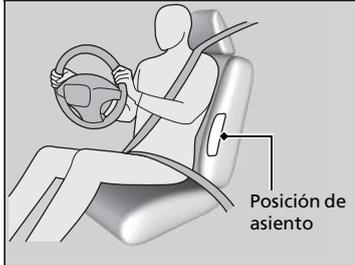
Los airbags laterales se alojan en el borde exterior de los respaldos del conductor y del acompañante.
