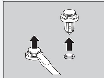
Introduzca el clip con el pasador central levantado y empuje hasta que quede plano.
