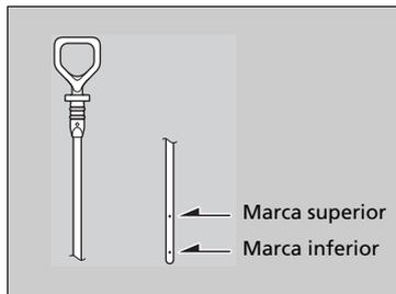
4. Retire de nuevo la varilla de medición del nivel y compruebe el nivel. Debería encontrarse entre las marcas superior e inferior. Si es necesario, añada aceite.
