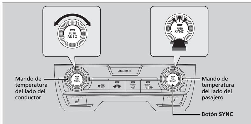
Es posible ajustar la temperatura sincrónicamente para el lado del conductor y del pasajero en el modo de sincronización.
