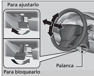
1. Tire de la palanca de ajuste del volante hacia arriba.
