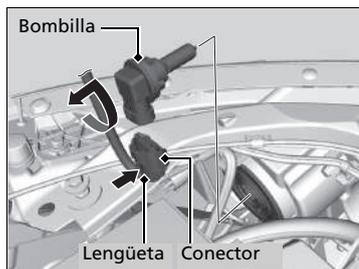
1. Presione la lengüeta para desmontar el acoplador.
