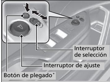
Puede ajustar los retrovisores cuando el interruptor de encendido está en la posición de CONTACTO
