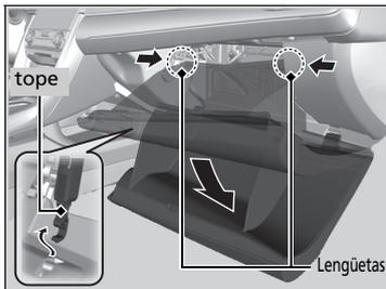
2. Empuje el tope de la guantera en el lado del conductor para sacarlo de la guantera.
