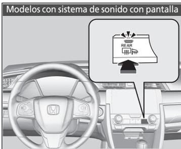
La luneta térmica y los retrovisores térmicos se desactivan automáticamente transcurridos de 10 a 30 minutos, en función de la temperatura exterior. Sin embargo, si la temperatura exterior es de 0 °C o inferior, no se desconectan automáticamente.
