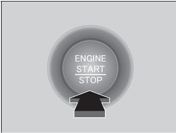
3. Pulse el botón **ENGINE START/STOP** sin pisar el pedal del acelerador.
