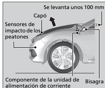
Cuando los sensores de impacto de los peatones detectan un determinado impacto, el sistema de apertura instantánea del capó se activa y la parte trasera del capó se levanta.
