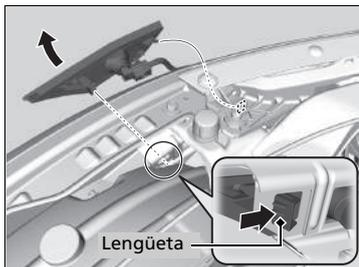
1. Presione la lengüeta para desmontar el conjunto de luces.
