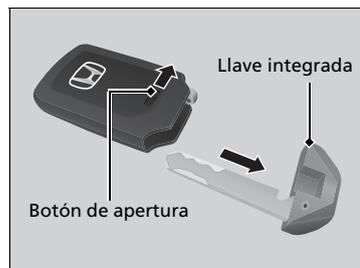
Se puede utilizar la llave integrada para bloquear/desbloquear las puertas cuando la pila del mando a distancia de acceso sin llave se está agotando y el bloqueo/desbloqueo eléctrico de las puertas está desactivado.
