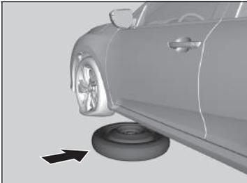
6. Coloque la rueda de repuesto (con la llanta hacia arriba) debajo del vehículo, cerca del neumático que va a sustituir.
