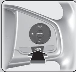
Si se enciende un testigo diferente, pulse el botón **LIM** para cambiar al control de crucero.
