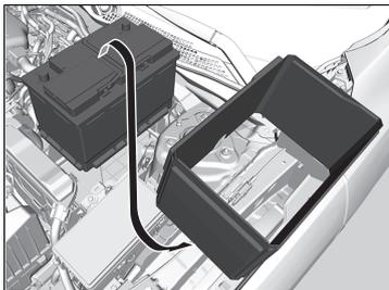
6. Retire la cubierta de la batería.
