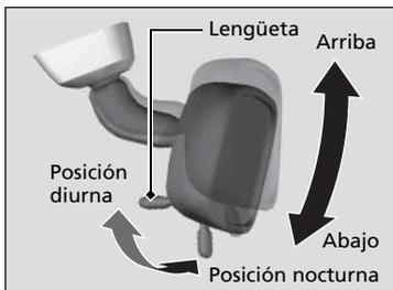
Dé la vuelta a la lengüeta para cambiar la posición. La posición nocturna contribuye a reducir el resplandor de los faros de los vehículos posteriores después del crepúsculo.
