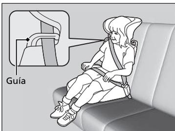
Hay disponible un respaldo para un elevador para niños concreto. Instale el respaldo en el elevador para niños y ajústelo al asiento del vehículo siguiendo las instrucciones del fabricante del elevador. Asegúrese de que el cinturón de seguridad pasa correctamente a través de la guía del hombro del respaldo y que no toca ni cruza el cuello del niño.
