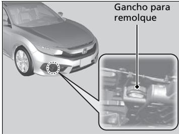
1. Enganche el dispositivo de remolque al gancho para remolque.
