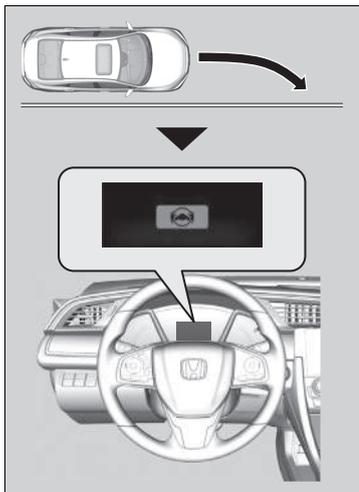
La cámara delantera detrás del retrovisor controla marcas de carril a la izquierda y a la derecha (en blanco o amarillo). Si su vehículo está acercándose demasiado a las marcas del carril detectadas sin ningún intermitente encendido, el sistema, además de una alerta visual, ejerce resistencia en la dirección y le avisa con vibraciones rápidas en el volante con el fin de ayudarle a permanecer dentro del carril detectado.
