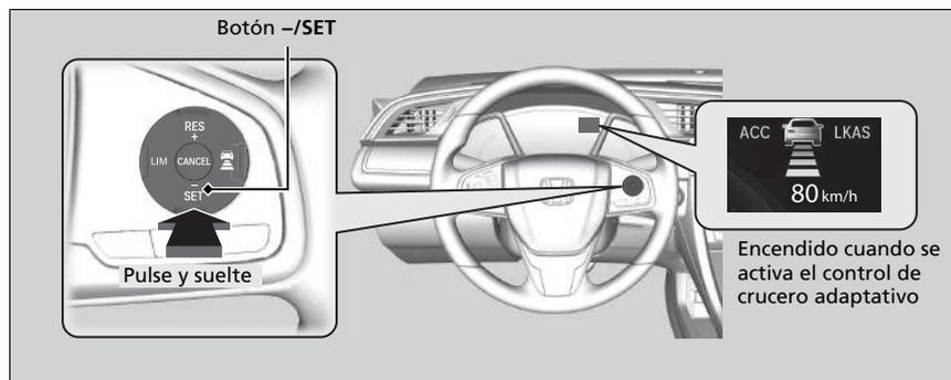
Levante el pie del pedal y pulse el botón **-/SET** cuando alcance la velocidad deseada.
