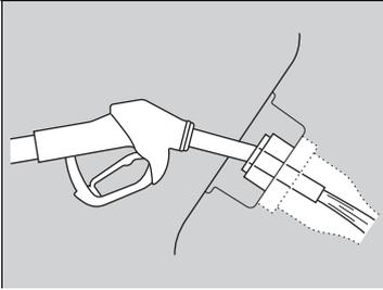
5. Coloque el extremo de la boquilla de llenado en la parte inferior de la boca de llenado y, a continuación, insértela lentamente y hasta el fondo.
