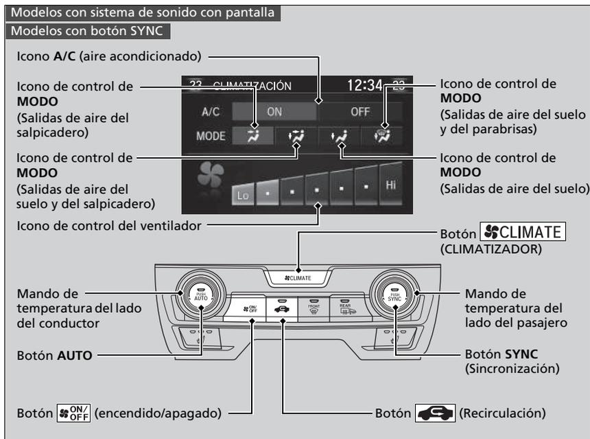
Utilice el sistema con el motor en marcha.
