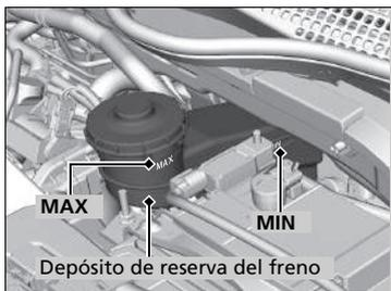
El nivel del líquido debe estar entre las marcas **MIN** y **MAX** del lateral del depósito de reserva.
