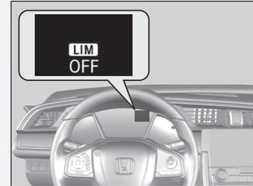
Si hay un problema con el sistema cuando está utilizando el limitador de velocidad ajustable, suena el avisador acústico y se enciende **OFF**. El limitador de velocidad ajustable se desactivará.
