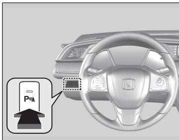
Con el interruptor de encendido en la posición de CONTACTO **II**\*1, pulse el botón del sistema del sensor de estacionamiento para activar o desactivar el sistema. El testigo del botón se enciende cuando el sistema está activado.
