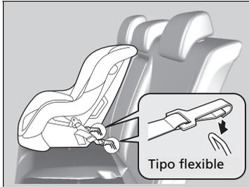
3. Coloque el sistema de sujeción para niños en el asiento del vehículo y después fíjelo a los anclajes inferiores según las instrucciones del sistema.
