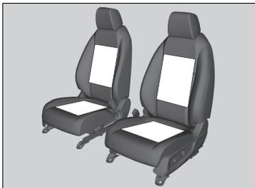
El interruptor de encendido debe estar en la posición de CONTACTO
