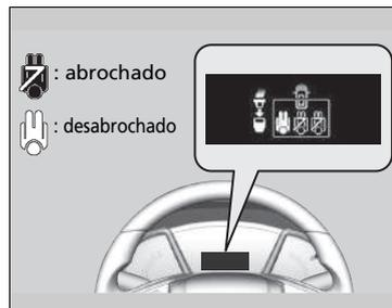
El vehículo supervisa el uso de los cinturones de seguridad de los asientos traseros. Una interfaz de información para el conductor indica si se está utilizando alguno de los cinturones de seguridad de los asientos traseros.
