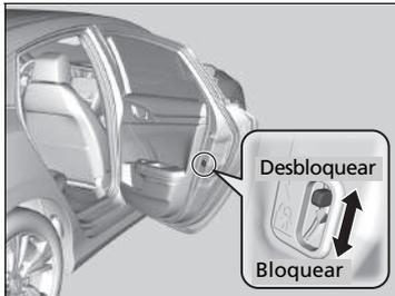
Mueva la palanca de la puerta trasera a la posición de bloqueo y cierre la puerta.
