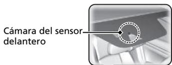
Cámara del sensor delantero
