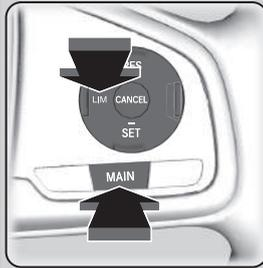
Si se enciende un testigo diferente, pulse el botón **LIM** para cambiar al limitador de velocidad inteligente.
