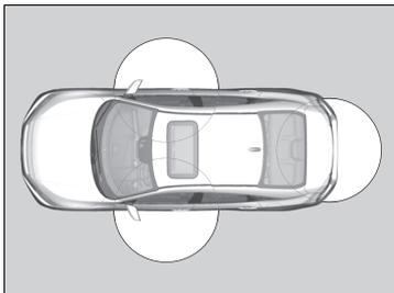
Cuando lleva encima el mando a distancia sin llave, puede bloquear/desbloquear las puertas, la tapa del depósito de combustible y abrir el maletero. Puede bloquear/desbloquear las puertas y la tapa del depósito de combustible dentro de un radio de unos 80 cm del exterior de la manecilla de la puerta. Se puede abrir el maletero dentro de un radio de 80 cm desde el botón de apertura del maletero.
