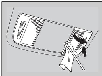
1. Presione el cristal del lado opuesto a la bombilla que va a sustituir.
