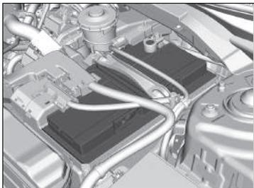
El estado de la batería se controla con un sensor ubicado en el terminal negativo de la batería. Si hay un problema con este sensor, la interfaz de información para el conductor mostrará un mensaje de advertencia. Si esto sucede, solicite que le revisen el vehículo en un concesionario.
