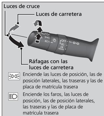
Al girar el interruptor de luces, se encienden y apagan las luces con independencia del modo de alimentación o la posición del interruptor de encendido.
