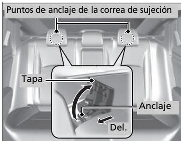
Hay un punto de anclaje para la correa de sujeción detrás de cada asiento trasero exterior.
