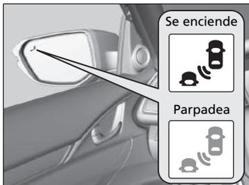
Testigo de alerta del BSI: Situado en los espejos retrovisores exteriores de ambos lados.
