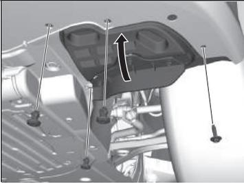
1. Retire los clips con un destornillador de punta plana, retire el perno y levante la tapa inferior.
