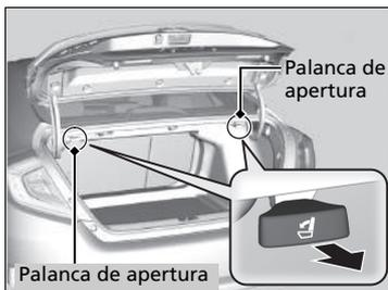
2. Tire de la palanca de apertura situada en el maletero para liberar el mecanismo de bloqueo.
