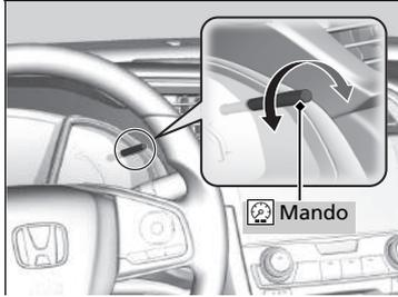
Al encender las luces con el interruptor de encendido en la posición de CONTACTO **II** <sup>\*1</sup>, se puede ajustar el brillo del panel de instrumentos con el mando de brillo.
