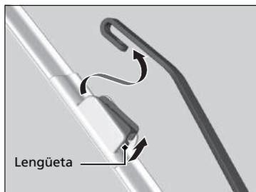
4. Mantenga pulsada la lengüeta y, a continuación, deslice el soporte para sacarlo del brazo del limpiaparabrisas.
