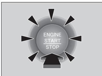
2. Pise el pedal de embrague y pulse el botón **ENGINE START/STOP** en un intervalo de 10 segundos después de que haya sonado el avisador acústico y el botón **ENGINE START/STOP** pase de parpadear a estar fijo.
