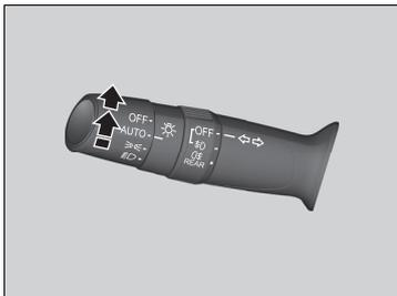
El control automático de luces se puede utilizar con el interruptor de encendido en la posición de CONTACTO
