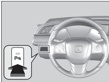
Con el interruptor de encendido en la posición de CONTACTO **II**\*1, pulse el botón del sistema del sensor de estacionamiento para activar o desactivar el sistema. El testigo del botón se enciende cuando el sistema está activado.
