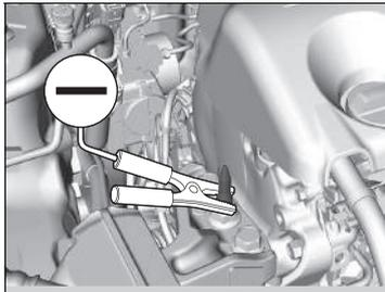
5. Conecte el otro extremo del segundo cable de arranque con pinzas al tornillo de montaje del motor como se muestra en la imagen. No conecte este cable de arranque con pinzas a ninguna otra parte.
