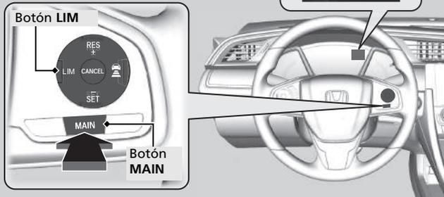
Si aparece un panel de instrumentos distinto, pulse el botón **LIM** para cambiarlo al de control de crucero adaptativo.
