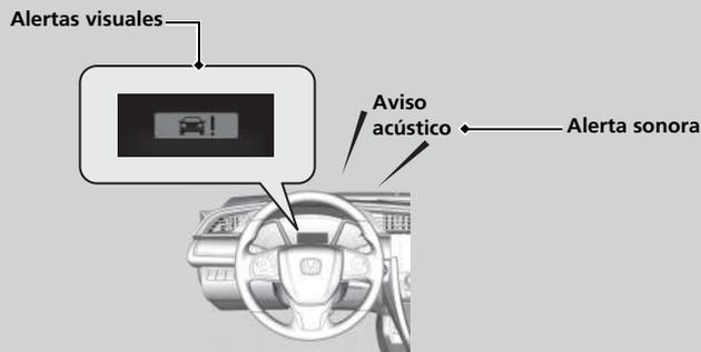
Desde las opciones de ajuste de la interfaz de información para el conductor o la pantalla de audio/información, en la fase de alerta de colisión del sistema, puede cambiar la distancia (**Lejos/Normal/Cerca**) entre los vehículos a la que se producirá la alerta.
