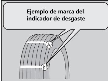
La ranura en la que está situado el indicador de desgaste es 1,6 mm más profunda que cualquier otro punto del neumático. Si la banda está desgastada y el indicador queda visible, sustituya el neumático. **Los neumáticos desgastados presentan una tracción deficiente en calzadas mojadas.**
