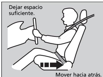
Ajuste el asiento del conductor lo más atrás posible siempre que le permita mantener el control total del vehículo. Deberá poder sentarse con la espalda recta bien apoyada en el respaldo y pisar adecuadamente los pedales, sin tener que inclinarse hacia delante, y agarrar el volante con comodidad. El asiento del acompañante deberá ajustarse de forma similar para que permanezca lo más lejos posible del airbag delantero del salpicadero.
