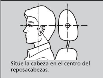
Los reposacabezas delanteros resultan más efectivos para evitar el llamado efecto latigazo y otras lesiones por impacto trasero cuando la parte central posterior de la cabeza del ocupante está a la altura del centro del reposacabezas. La parte superior de las orejas del ocupante debe quedar a la altura del centro del reposacabezas.
