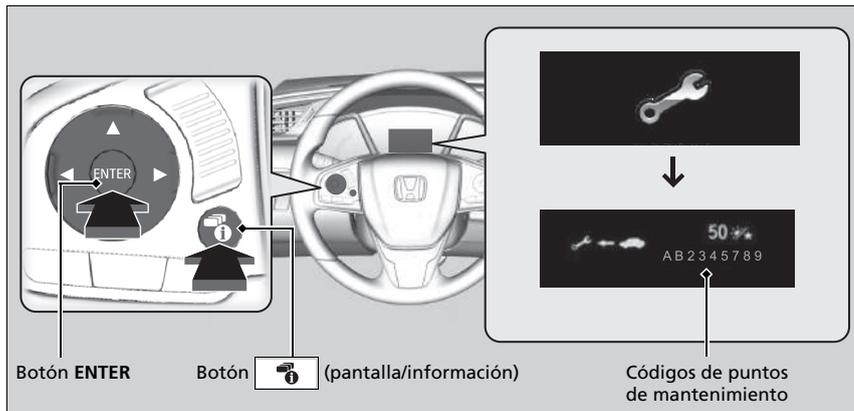
El testigo de mensajes del sistema (
