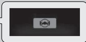
Cuando accione las señales de giro para cambiar de carril, el sistema quedará suspendido y se reanudará una vez que las señales vuelvan a la posición de desactivación. Si hace un cambio de carril sin accionar las señales de giro, las alertas del LKAS se activarán y se aplicará el par a la dirección.
