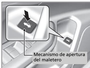
Al pulsar el mecanismo de apertura del maletero de la puerta del conductor, se desbloquea y abre el maletero.
