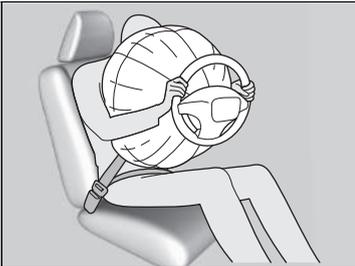
Mientras el cinturón de seguridad sujeta el torso, el airbag delantero ofrece protección suplementaria para la cabeza y el tórax.
