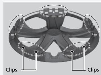
Alinee la marca de la válvula del tapacubo con la válvula del neumático de la rueda; a continuación, instale el tapacubo.
