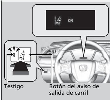
Pulse el botón del sistema de aviso de salida de carril para encender y apagar el sistema.
