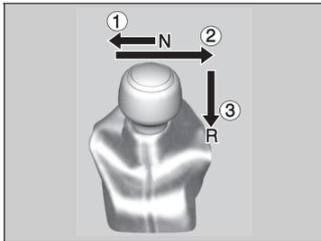
1. Pise el pedal de embrague, mueva la palanca de cambios a tope hacia la izquierda y cambie a la posición **R**.
