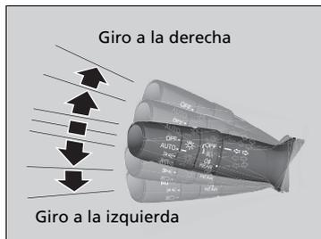
Los intermitentes se pueden utilizar cuando el interruptor de encendido está en la posición de CONTACTO
