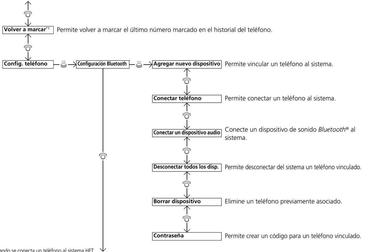
\*1: Aparece solamente cuando se conecta un teléfono al sistema HFT.
