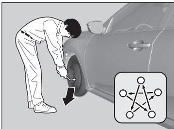
1. Retire las tuercas de rueda y el neumático pinchado.
