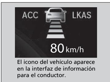
Cuando un vehículo a menor velocidad que la que usted ha programado se aproxima o le adelanta, y el radar y la cámara lo detectan, su vehículo empieza a desacelerar.
