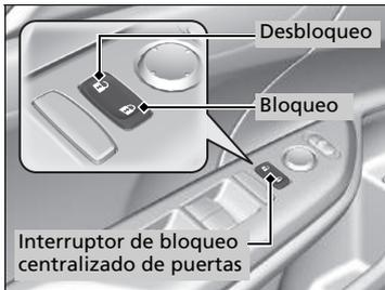
Pulse el interruptor de bloqueo centralizado de puertas hacia dentro como se muestra para bloquear o desbloquear todas las puertas y el maletero.
