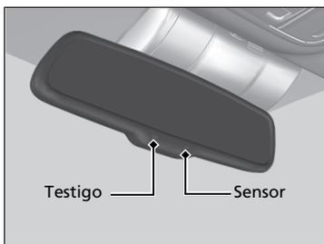
Cuando esté conduciendo por la noche, el retrovisor y el retrovisor eléctrico con atenuación automática reducen el brillo reflejado de los faros de los coches que circulan por detrás, en función de las señales del sensor del retrovisor. Esta característica está siempre activa.
