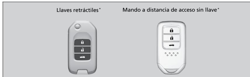
Use las llaves para arrancar y parar el motor, y para bloquear y desbloquear las puertas, el maletero y la tapa del depósito de combustible. También puede usar el mando a distancia para bloquear y desbloquear las puertas, el maletero y la tapa del depósito de combustible.
