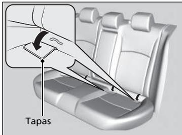
2. Tire hacia fuera de las tapas del anclaje bajo las marcas para dejar al descubierto los anclajes inferiores.
