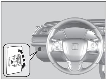
Puede ajustar el ángulo vertical de las luces de cruce cuando el interruptor de encendido está en la posición de CONTACTO **II**.
