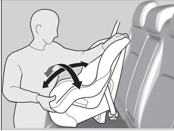
6. Asegúrese de que el sistema de sujeción para niños esté firmemente sujeto balanceándolo hacia delante, atrás y lateralmente; deberá notarse poco movimiento.
