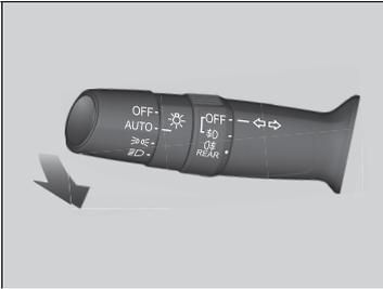
Desactive el sistema cuando el vehículo esté estacionado con el interruptor de encendido en la posición de CONTACTO **II**<sup>\*1</sup> y el interruptor de las luces en la posición **AUTO**.
