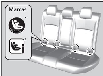
1. Localice las marcas del anclaje fijadas en la base del cojín del asiento.
