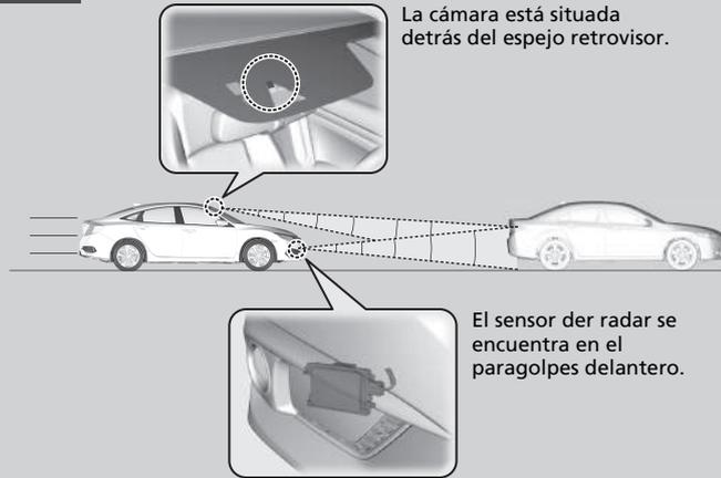
El sistema empieza a supervisar la calzada cuando la velocidad del vehículo es de unos 5 km/h y delante de usted está circulando otro vehículo.
