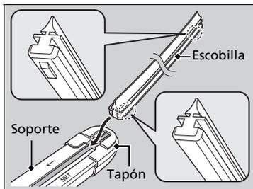
7. Inserte el lado plano de la escobilla nueva hasta la parte inferior del soporte. Inserte la escobilla hasta el final.
