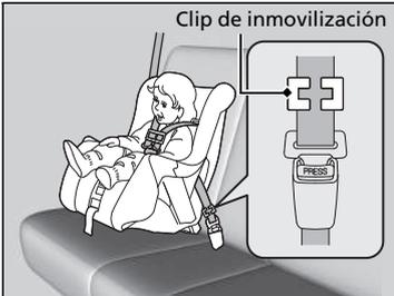
3. Sujete con firmeza el cinturón cerca de la hebilla. Mantenga sujetas las dos partes del cinturón para que no se deslicen por la hebilla. Desabroche el cinturón de seguridad.
