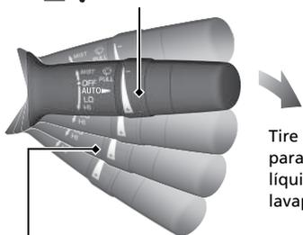
Tire hacia usted para pulverizar líquido del lavaparabrisas.
