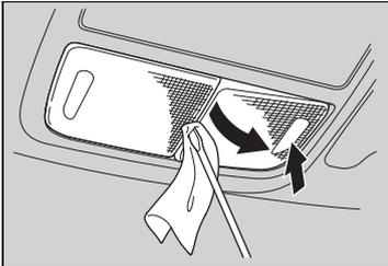
1. Presione el cristal del lado opuesto a la bombilla que va a sustituir.
