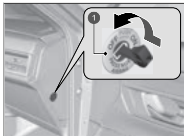
1 Interruptor ON/OFF del airbag del pasajero delantero
