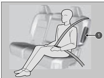
1 Ubicación de los airbags laterales
