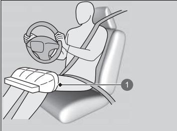
Cuando se infla el airbag delantero del conductor, también lo hace el airbag de rodilla del conductor.
