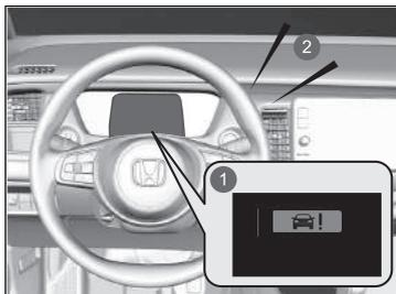
El sistema proporciona avisos visuales y acústicos de una posible colisión, y se detiene si se evita el choque.
