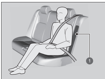
1 Ubicación de los airbags laterales
